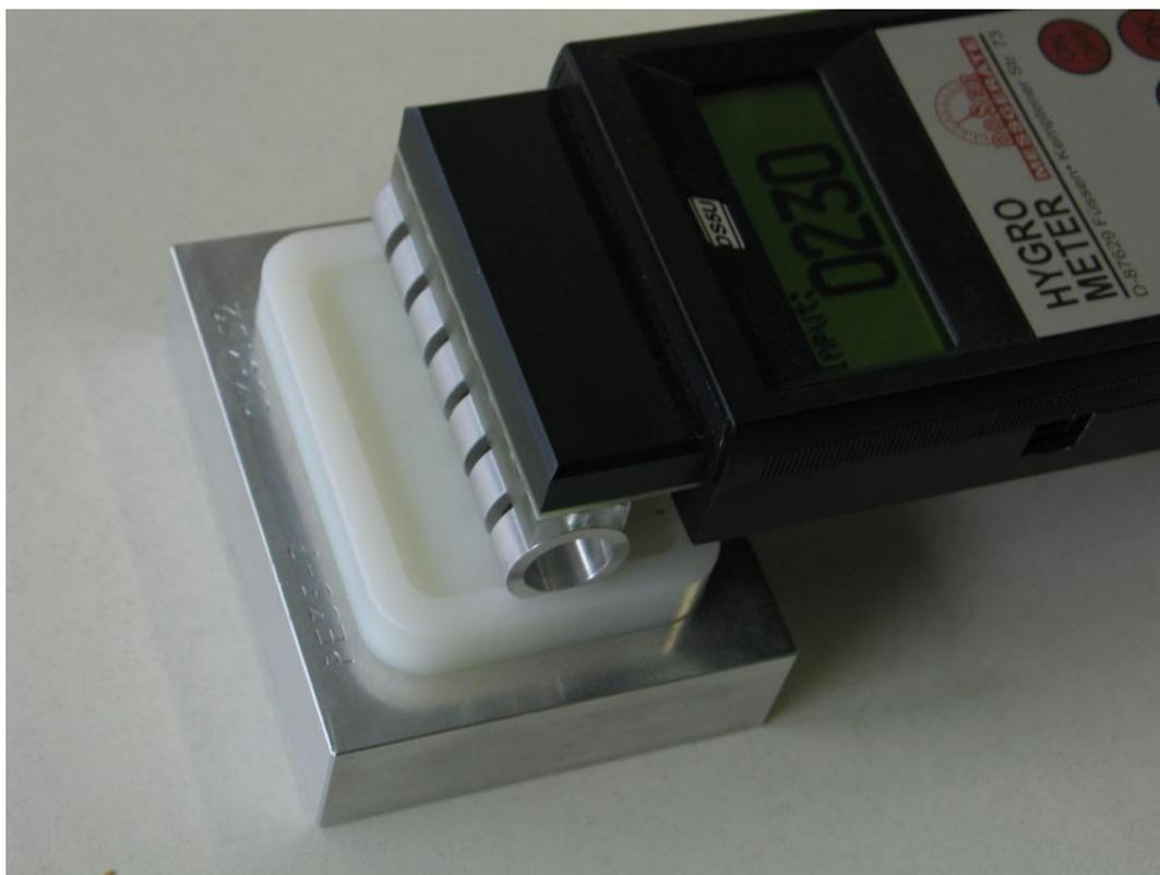
Das Testmodul PE35-7 kann zum Testen und Kalibrieren unserer Messgeräte DM7-AL und DS7U verwendet werden.
