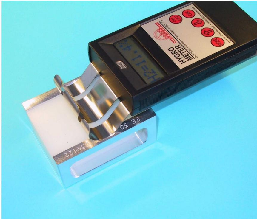
Der Testmodul PE30 dient zur Überprüfung, Kalibrierung unserer kapazitiven Feuchtigkeitsmessgeräte.
